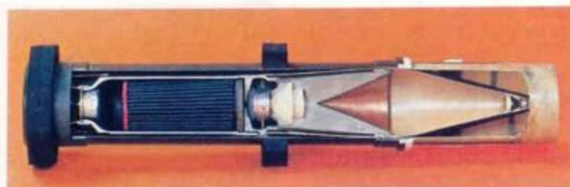
Engin anti-char léger de calibre 89 mm dans son conteneur, exécuté, ainsi que l'arme, en enroulement filamentaire (verre résine).
