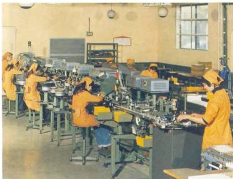
Chaîne assurant le montage et le contrôle d'ensembles complexes de micromécaniques ; cadence 700 pièces/heure.
