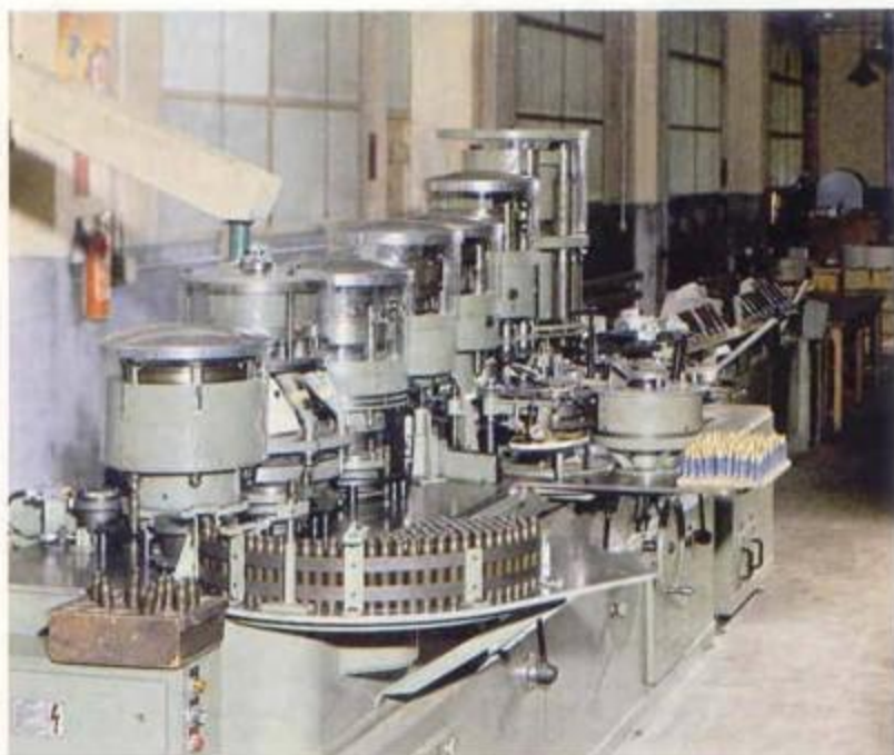
Machine d'assemblage en cinématique continue, effectuant : dosage de produits en poudre, assemblage et contrôle dimensionnel des différents éléments constituant certains dispositifs pyrotechniques ; cadence : 4.000 ensembles/heure.
